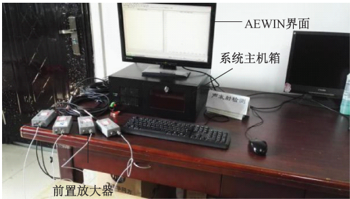
图5 声发射检测系统 Fig. 5 AE testing system
