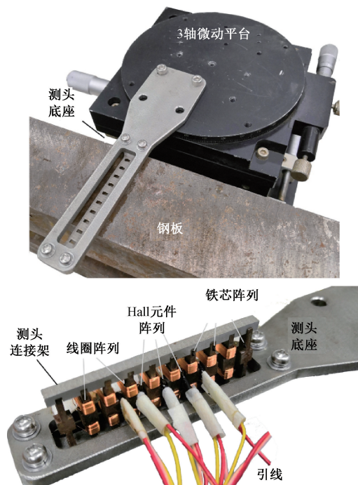
图 12 阵列传感器测头安装到微动平台构成位移测量实验装置
