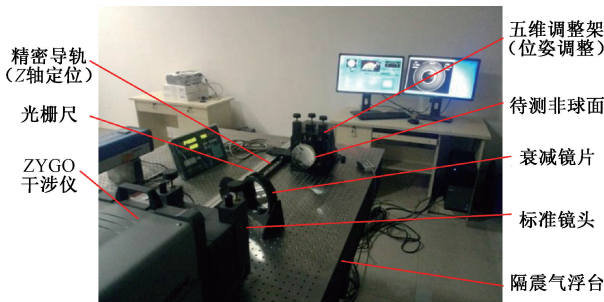
图3 基于 ZYGO 干涉仪的非球面测量平台
