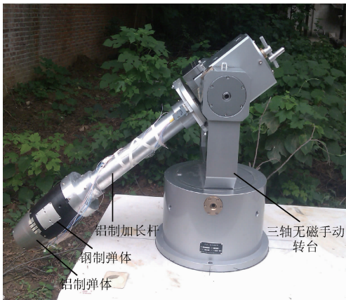
图6 地磁误差校正用三轴转台
