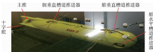
图 6 BSAV-II 型欠驱动 UUV
