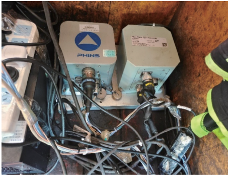
图8 PHINS 和 INS Fig. 8 PHINS and INS
