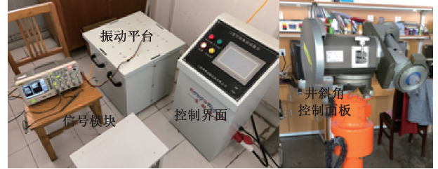
图 7 振动平台测试系统
