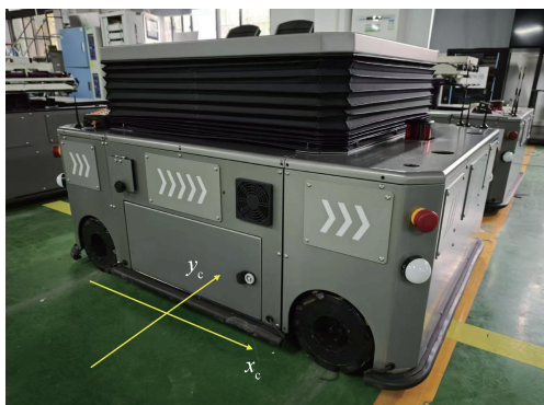
图 11 试验用麦克纳姆轮驱动机器人
