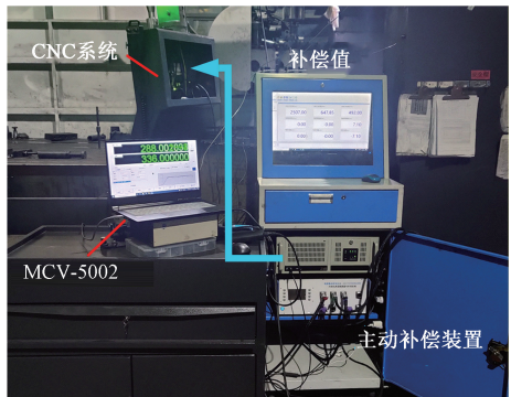
图 18 机床误差测量与主动补偿现场试验
