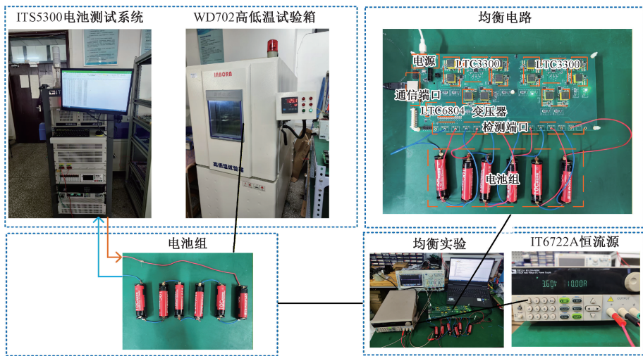
图 15 电池参数识别及主动均衡电路 Fig. 15 Battery parameter identification and active balancing circuit diagram
