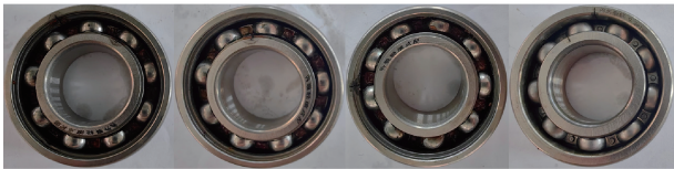
内圈外圈滚珠故障 内圈和滚珠故障 外圈和滚珠故障 内圈和外圈故障
