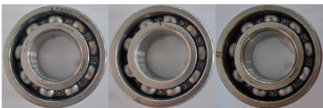
外圈故障 内圈故障 滚珠故障
